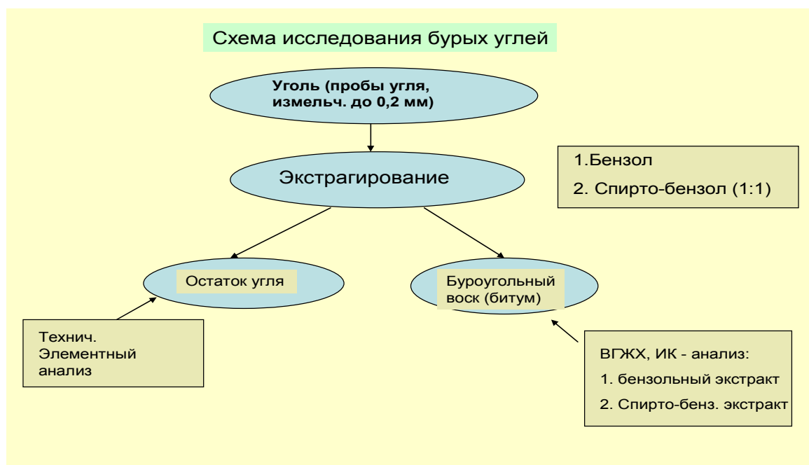
Рисунок 1. Схема экстрагирования угля
