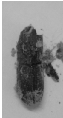
Рисунок 1. Образец необработанной древесины после огневой обработки
