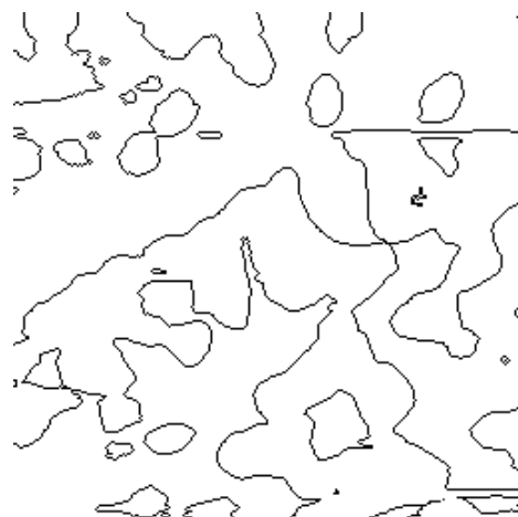
Рис. 6. Фрактальная структура покрытия Mn-Fe-Cu-Al
