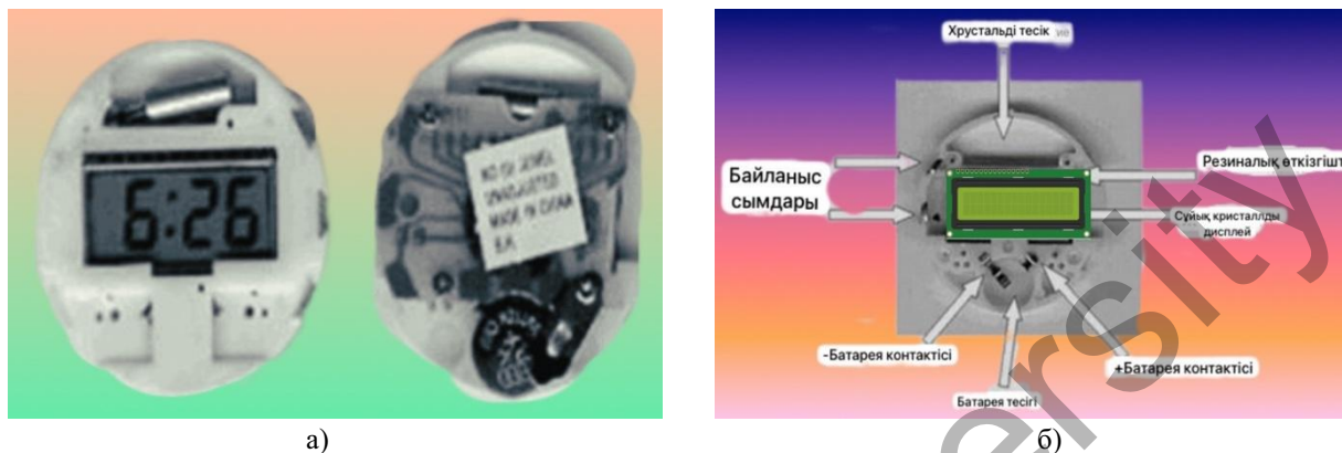
2-сурет. Сағаттың ішкі корпусының көріністері: алдыңғы (а) және артқы (б).
