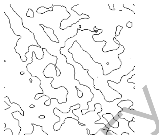
Рисунок 4. Фрактальная структура покрытия Cr-Mn-Si-Cu-Fe-Al
