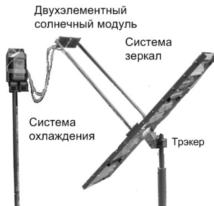
Рисунок 1. Опытный образец-прототип концентраторной гибридной тепло-фотоэлектрической системы ТФЭП с пиковой мощностью 45 Вт с солнечной концентрацией C = 8 . Приведена конструкция с двумя солнечными элементами
