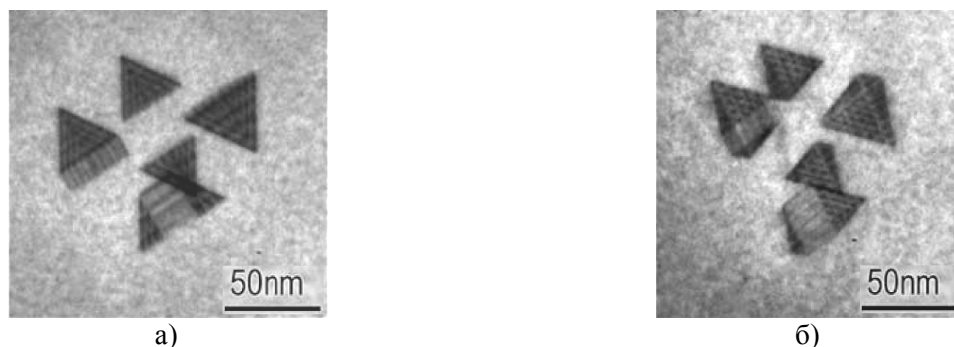
Рис. 16. Тетраэдры дефектов упаковки в золоте, наблюдаемые с помощью электронного микроскопа: а, б) — группа ТДУ под двумя различными углами [13]
