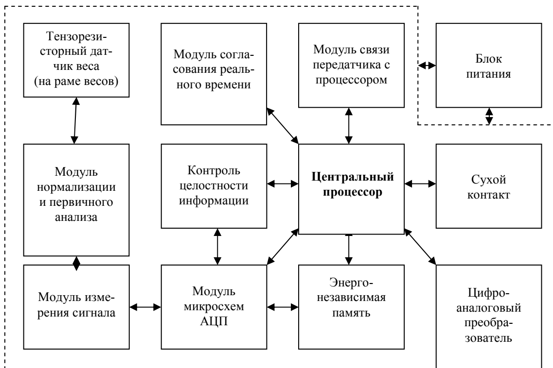
Рисунок 3. Структурная схема универсального аналого-цифрового преобразователя
