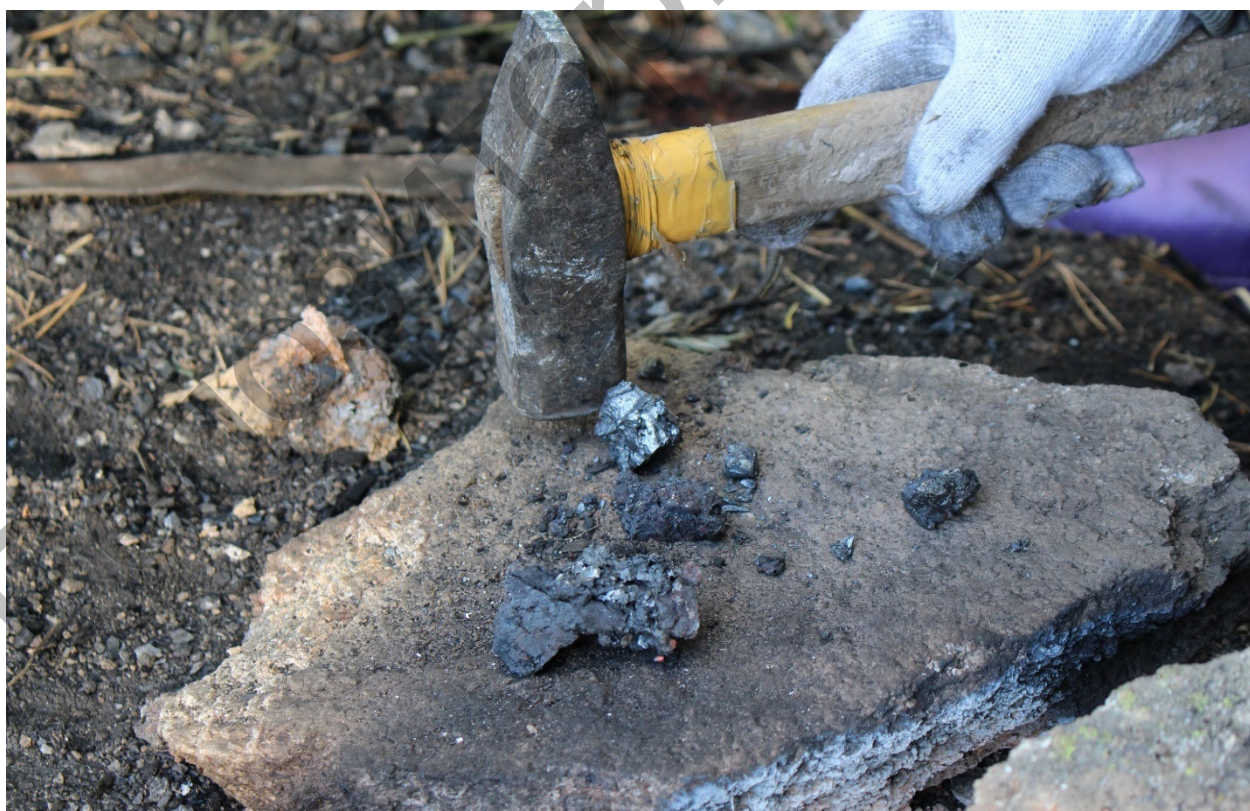
Металлургический комплекс Алат. Реконструкции печи. Результат эксперимента – получения крицы
