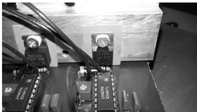
Рисунок 5. Крепление транзисторов на радиаторную основу из алюминия
