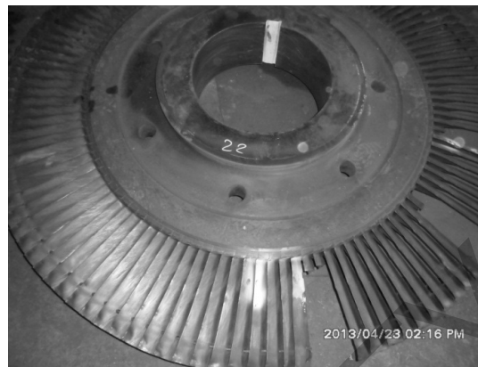
Рисунок 4. Общий вид разрушения лопаток 22 ступени РСД т/а Т-100/120-130
