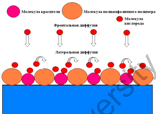
Рис. 78. Схема кислородопроницаемого гибридного ЛБ-монослоя полиамфолита и красителя
