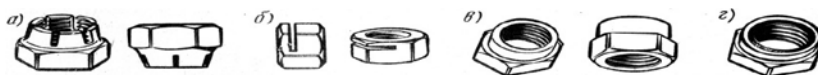
Сурет. 2.82. Өзі түйісетін гайкалар. а- конусты гайка, конусты бөлігі бойынша қысылған; б- мұртшасы иілген қиылған гайка; в- эллипс бойынша конусты бөлікте қысылған; г- конусты бөлігінде нейлонды қоспасы бар гайка.
