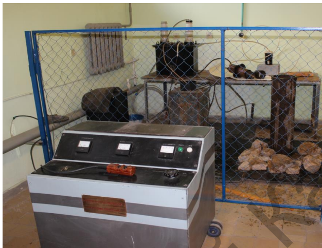
Сурет 2.5 - Тәжірибелік электрогидравликалық қондырғы
