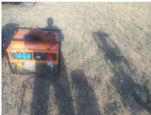
Сурет 2.23 – Қондырғыны электрмен қамтамасыз ететін бензинді генератор
