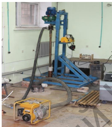
Сурет 2.9 – Зертханалық алаңдағы шағын көлемді бұрғылау қондырғысы
