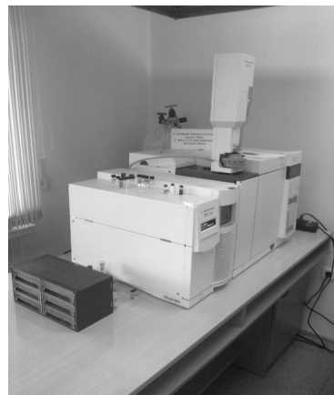
Сурет 2. Хроматограф Agilent Technologies 5975
