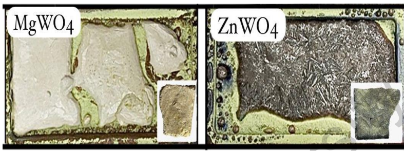
1-сурет. MgWO_4 , ZnWO_4 керамикалық үлгілерінің бейнесі.
