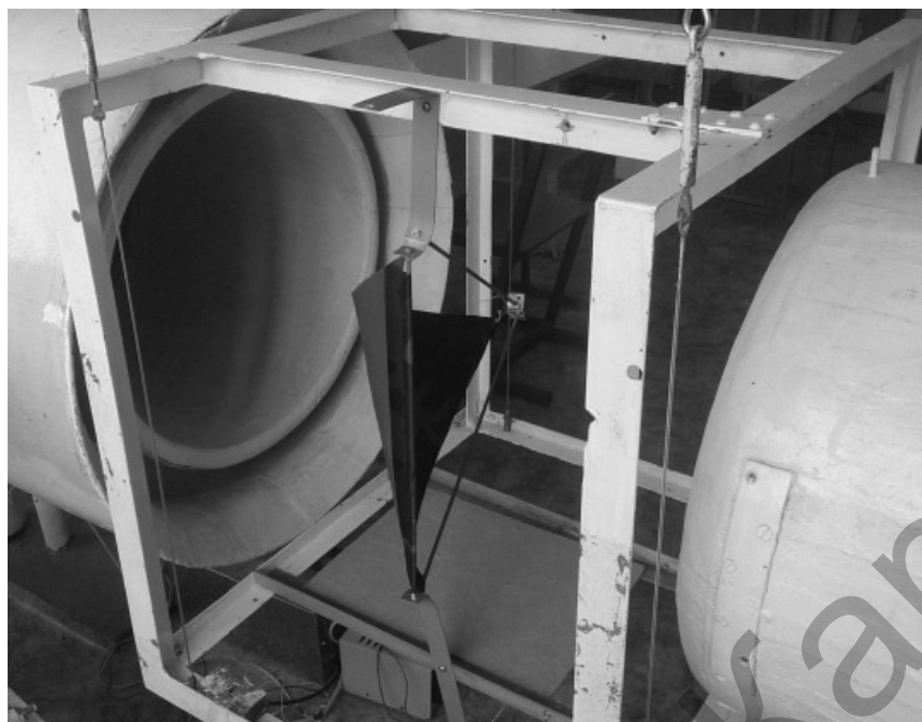
Рисунок 2. Расположение парусной лопасти в рабочей части аэродинамической трубы Т-1-М
