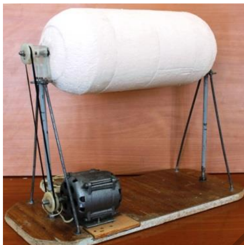
Рисунок 2.10 - Фотоснимок внешнего вида макета полусферического цилиндра с торцами диаметром 11 см
