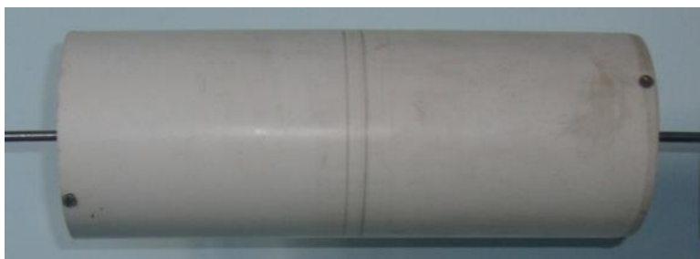
Рисунок 2.12 – Образец экспериментального цилиндра диаметром 18 см с гладкой поверхностью
