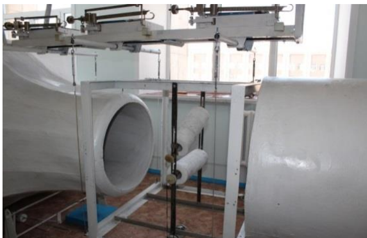
Рисунок 2.17 – Общий вид рабочей части аэродинамической трубы с установленной для исследования системой вращающихся цилиндров, расположенных под углом друг к другу
