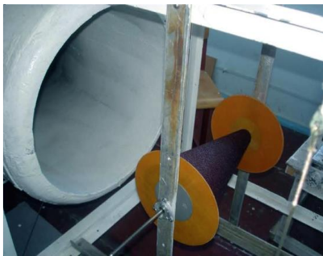
Рисунок 2.15 - Экспериментальная установка усеченного конуса с шероховатой поверхностью
