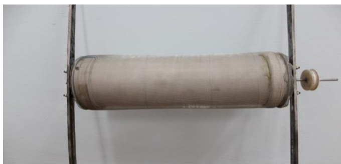
Рисунок 2.14 – Экспериментальный образец цилиндра с пористой поверхностью
