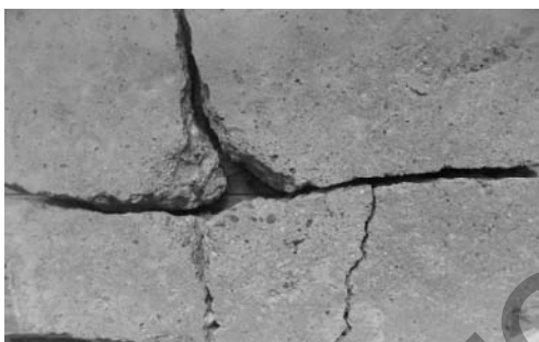
Рис. 5. Разрыв камня после бурения в течение 3 минут ( h = 30 мм)
