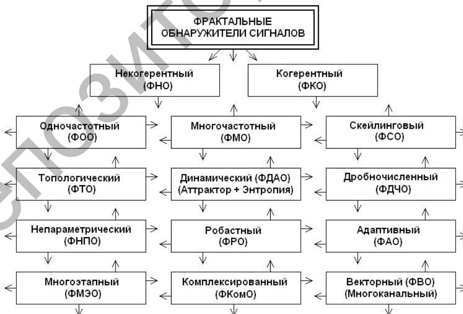
Рисунок 8. Основные виды предложенных автором фрактально-скейлинговых обнаружителей сигналов
