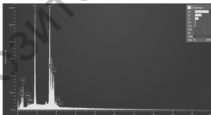
Рисунок 4. Элементный анализ стеклянной подложки с токопроводящим покрытием ИТО
