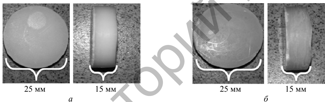
Рисунок 2. Образцы-излучатели пальмитиновой кислоты (а) и пальмитата меди (II) (б)
