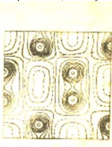
69- сурет. Алмаз кристаллында электронды тығыздықтың ыдырауы (Сұйықтың беттік проекциясы 100%)
