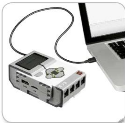
Рисунок 1.15 Подключение к компьютеру контроллера Lego
