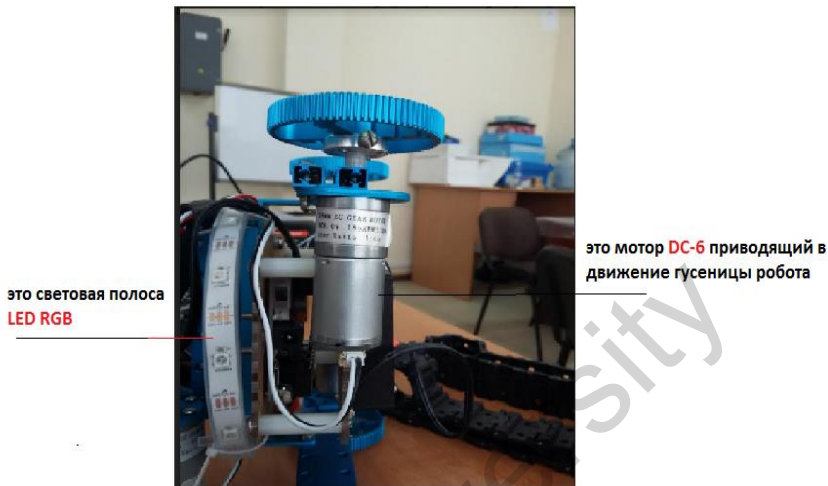
Рисунок 2.7 Мотор DC- 6, приводящий в движение гусеницы робота
