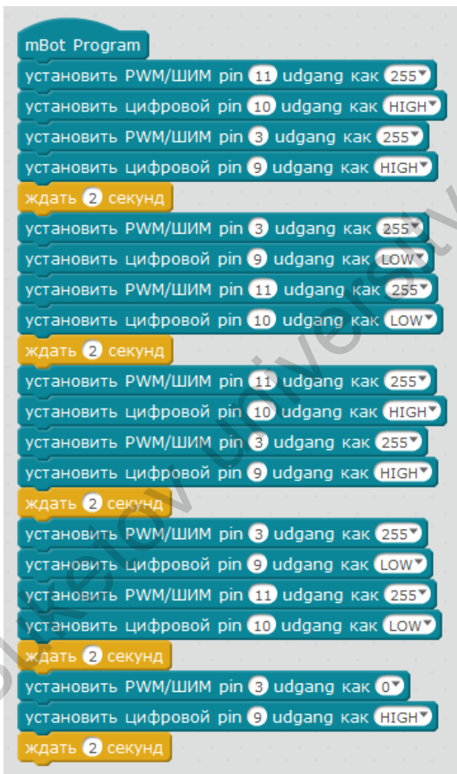
Рисунок 2.31 Пример программы по выполнению одновременных движений
