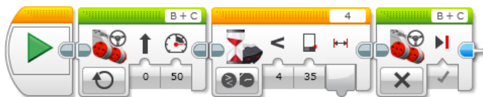
Рисунок 1.43 Пример использования ультразвукового датчика
