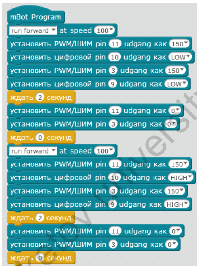
Рисунок 2.35 Пример программы управлению тремя группами моторов одновременно
