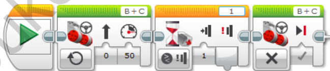
Рисунок 1.40 Пример использования датчика касания
