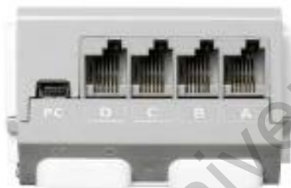
Рисунок 1.9 Порты для подключения Больших и Средних моторов
