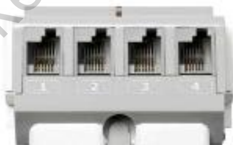
Рисунок 1.10 Это порты для подключения датчиков
