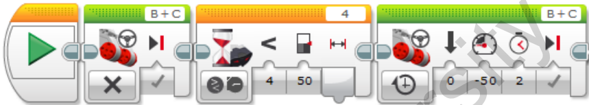
Рисунок 1.55 Инфракрасный датчик позволяет удерживать расстояние до объекта
