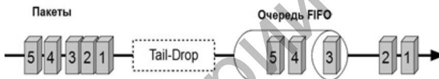
Рис. 1.35. Механизм передачи пакетов FIFO
