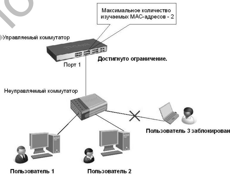
Рис. 2.4. Функция Port Security
