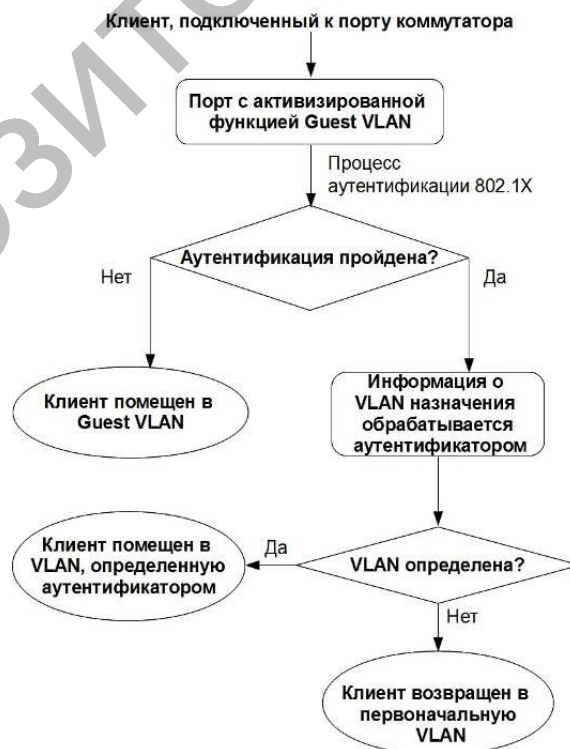
Рис. 1.25. Алгоритм процесса аутентификации с использованием Guest VLAN
