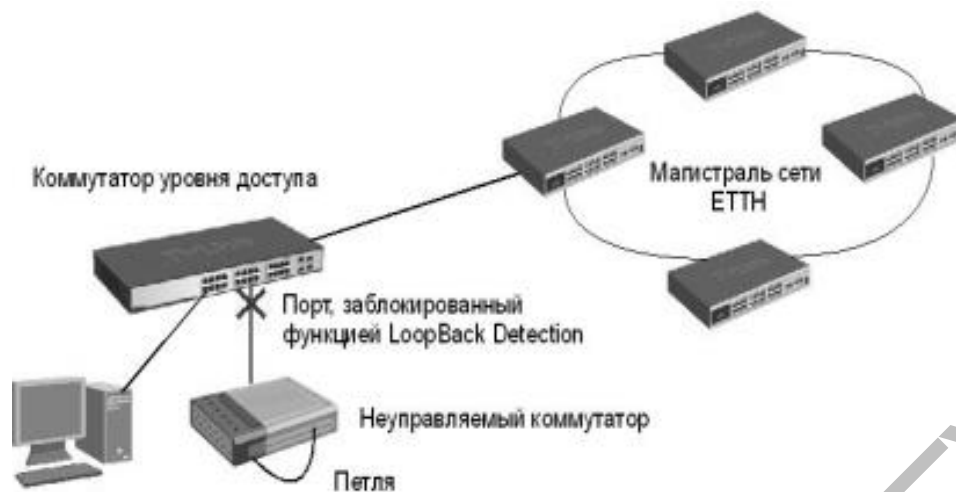
Рис. 1.15. Функция работы LoopBack Detection Independent STP
