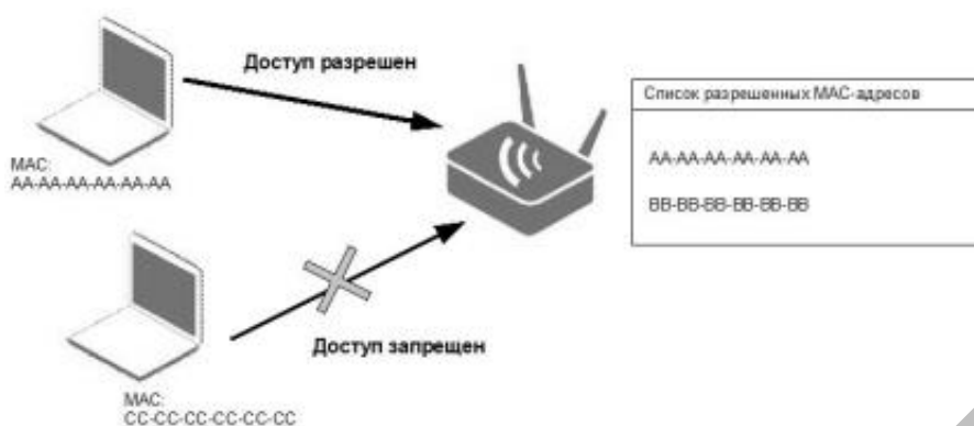
Рис. 2.21. Фильтрация по MAC-адресам
