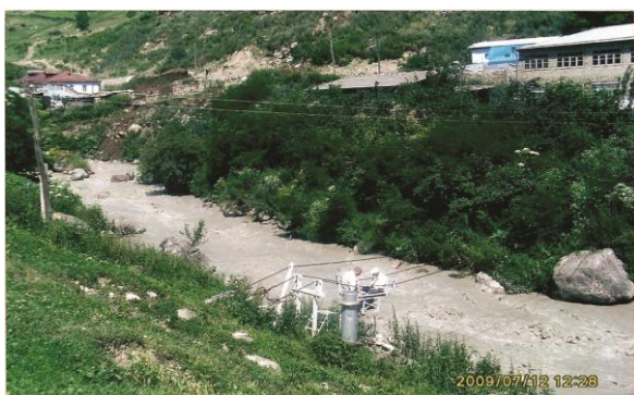
Измерение наибольших расходов воды и взвешенных наносов на в р. Гусарчай — с. Кузун
